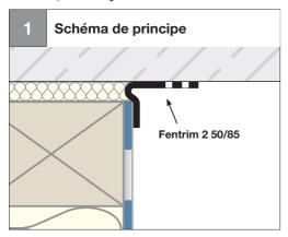
Raccordement d'un écran pour façade sur de la maçonnerie ou du béton non crépis
